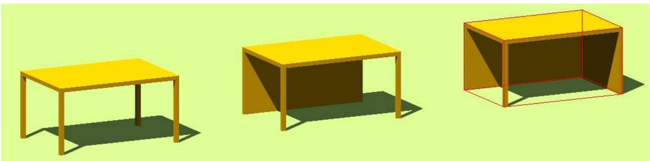
Abbildung 5: Die Beispielbilder zeigen Flugdächer mit verschiedenen Umschließungsanteilen. In der Mitte ist lediglich eine Langseite geschlossen. Es entsteht keine Baumasse. Rechts sind 50% der Umfassung durch Wände geschlossen. Zusammen mit der Stützkonstruktion an der offenen Hälfte ist knapp über 50% des Umfangs Umschließung und es entsteht somit die rot markierte Baumasse.
